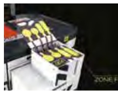
バキューム・ゾーン・フィット (必要な部分のみを熱成型)
